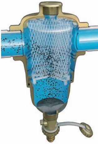
Действие сепарации, осуществляемое дешламентом, основано на использовании внутреннего элемента в виде сетчатых поверхностей, заменяющих общий фильтр. Сетка, по своей структуре, предоставляет низкое сопротивление проходу жидкости, обеспечивая, в любом случае, сепарацию.
