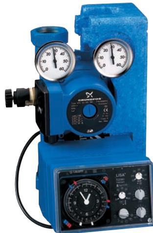
Блок регуляции температуры для системы центрального отопления для систем отопления и **охлаждения**. С изоляционным кожухом. Соединения первичного и вторичного контуров: 1" ВР с накидной гайкой. Максимальное рабочее давление: 6 бар. Диапазон контроля температуры: 20÷90°C. Питание: 230 В - 50 Гц.
