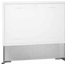
Шкаф для коллекторов серии 671 и 668...S1 и групп серии 182. Замок в виде бочка быстрого зацепления. Из окрашенной листовой стали. Регулируемая толщина: 110÷150 мм. Укомплектован подставками для напольной установки. Регулируемая высота: 270÷410 мм.
