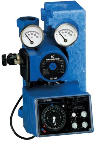
Блок регуляции температуры. С изоляционным кожухом. Соединения первичного и вторичного контуров: 1" ВР с накидной гайкой. Максимальное рабочее давление: 6 бар. Диапазон контроля температуры: 20÷90°C. Питание: 230 В - 50 Гц.
