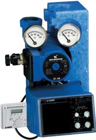
Блок регуляции температуры с цифровым программируемым термостатом среды и переключателем. С изоляционным кожухом. Соединения первичного и вторичного контуров: 1" ВР с накидной гайкой. Максимальное рабочее давление: 6 бар. Диапазон контроля температуры: 20÷90°C. Питание: 230 В - 50 Гц.
